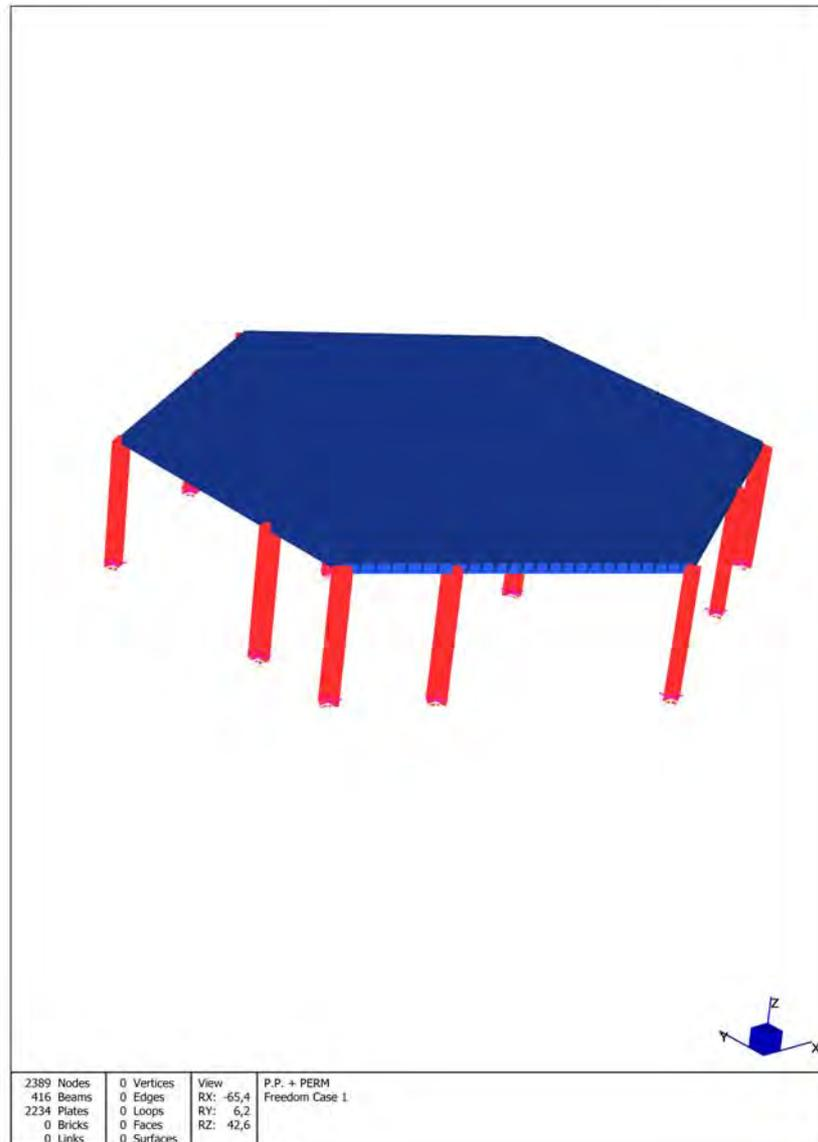
Messo a punto il modello, si è passati all'analisi modale della struttura, calcolo mediante il quale la distribuzione delle masse e dell'impianto delle rigidezze ha condotto a caratterizzare le frequenze proprie di oscillazione della costruzione. L'iter di calcolo ed i relativi risultati sono riportati qui di seguito.
