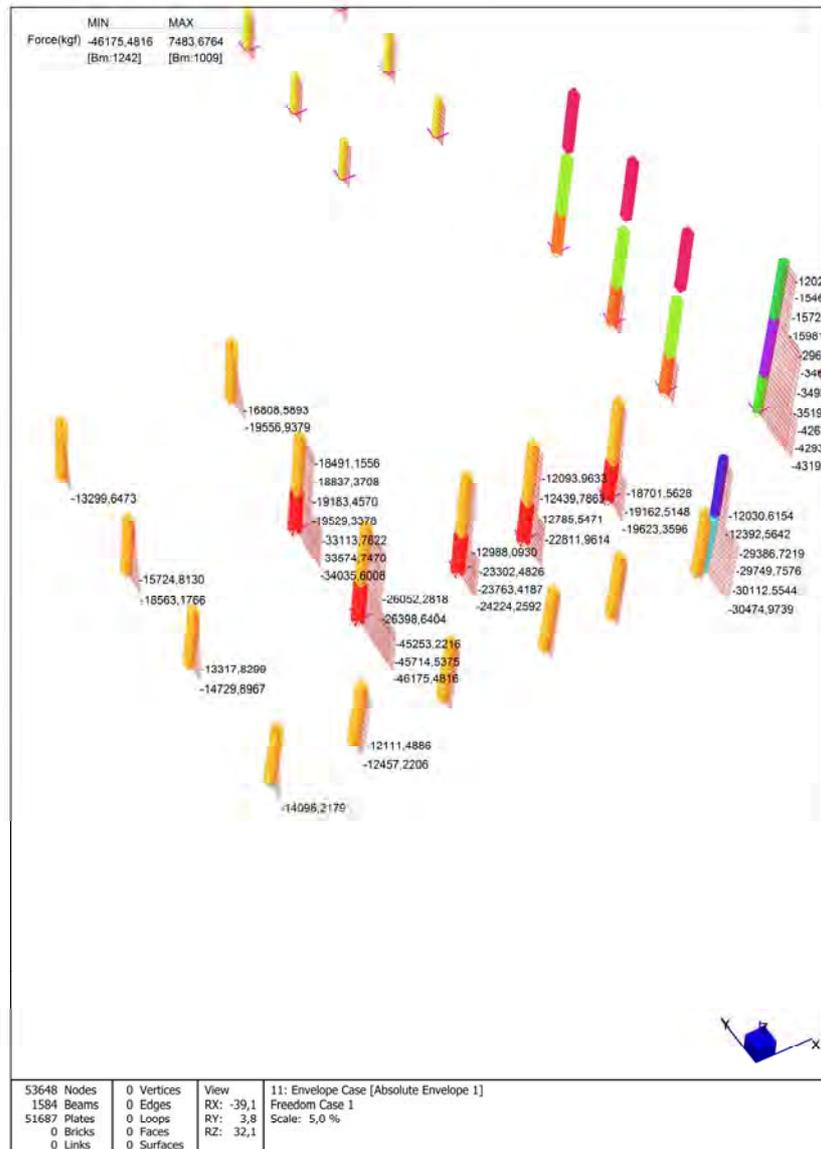
Combinazione di carico SLV con Involuppo del Sisma X Y, per verifica di presso flessione e taglio dei pilastri del corpo mensa esagonale, riportata nella Relazione.
